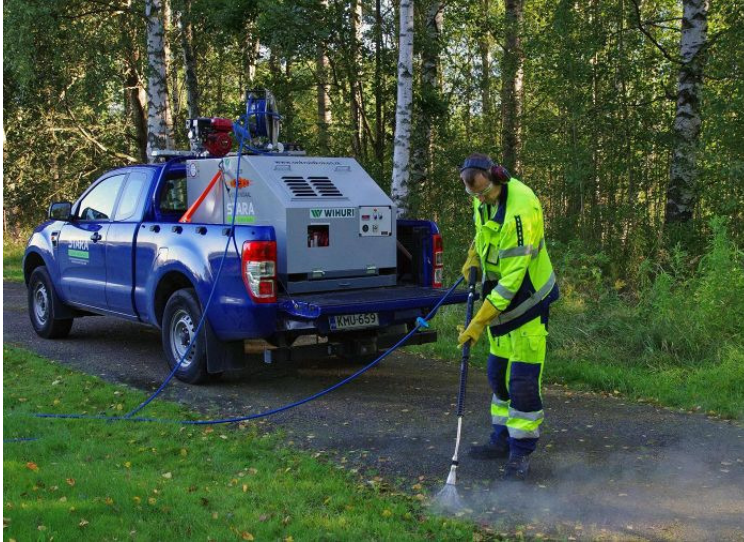
Staran Tamas Demeter torjumassa rikkakasveja hollantilaisella laitteella, jonka toiminta perustuu tulikuuman veden suihkuttamiseen.
